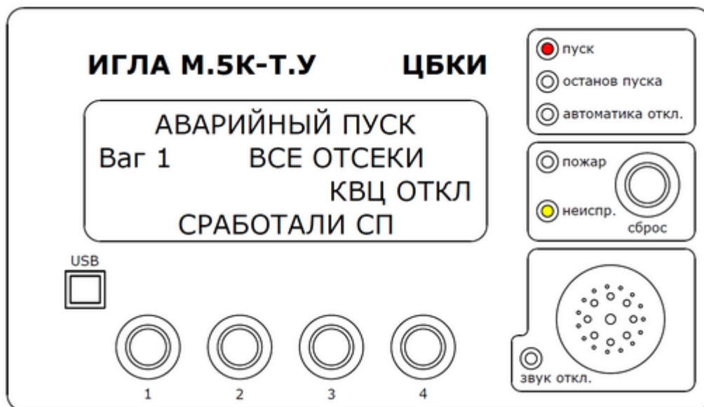
Рис. 27 – Состояние «АКТИВАЦИЯ СП»
