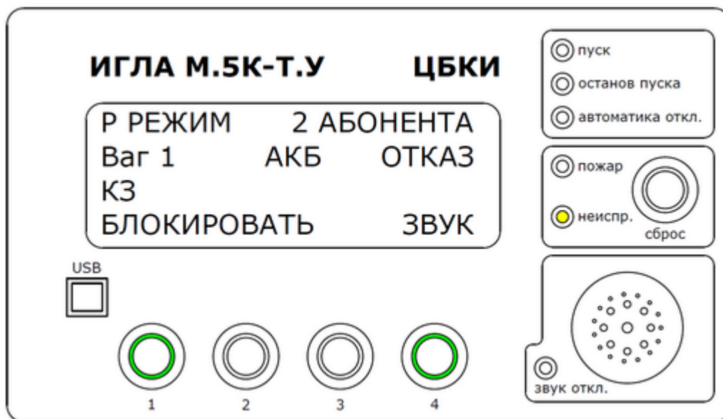
Рис. 31 – Блокировка неисправности «КЗ ШПС»
