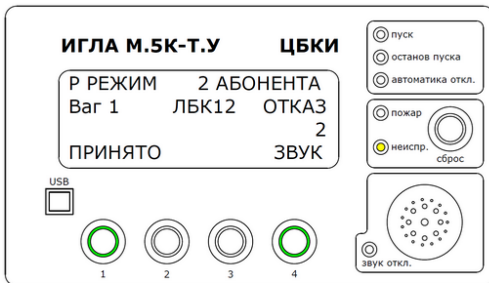
Рис. 37 – Состояние «ОТКАЗ ЛБК»
