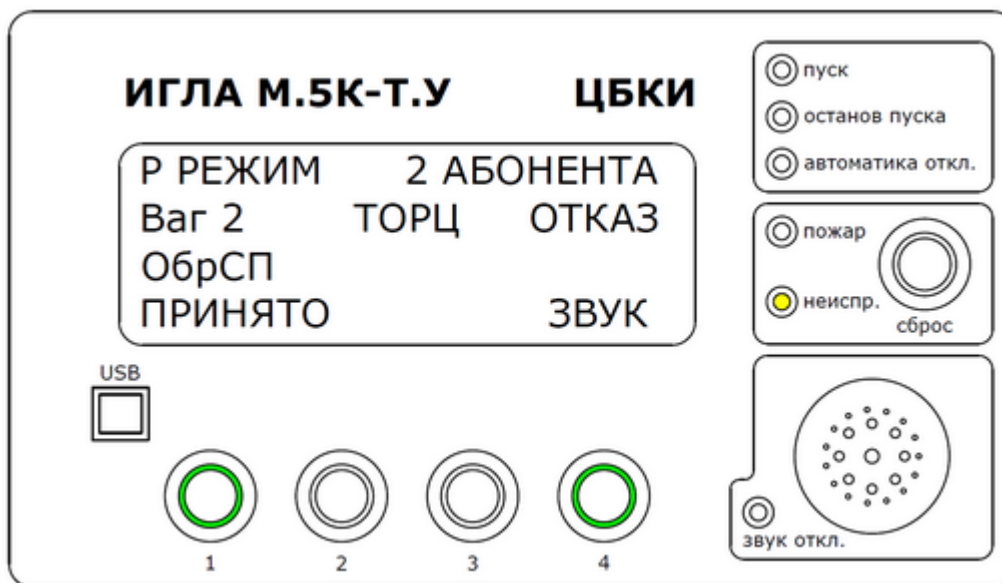
Рис. 32 – Состояние «Обрыв СП»
