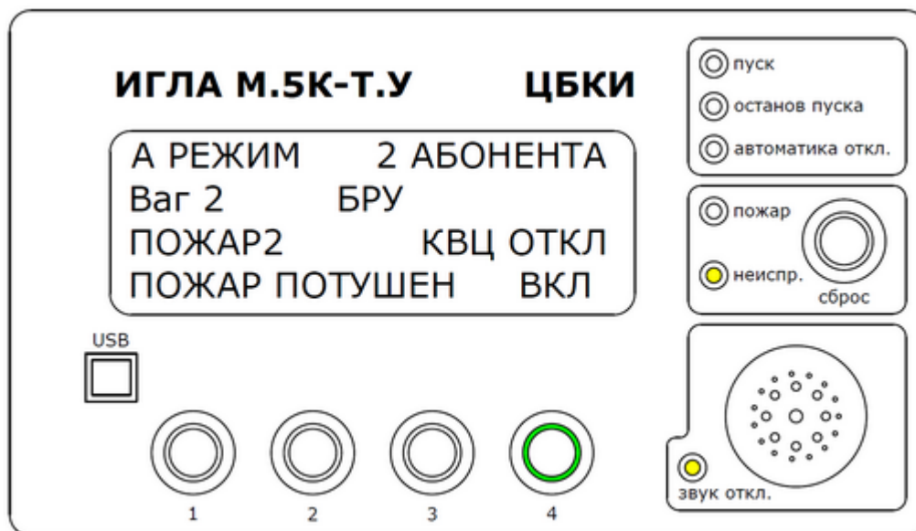
Рис. 11 – Состояние «ПОЖАР ПОТУШЕН» в А РЕЖИМЕ
