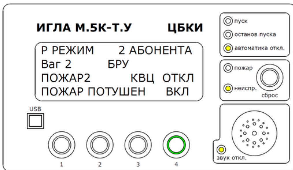
Рис. 17 – Состояние «ПОЖАР ПОТУШЕН» в Р РЕЖИМЕ
