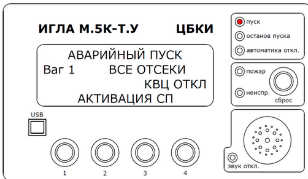
Рис. 26 – Состояние «АКТИВАЦИЯ СП»
