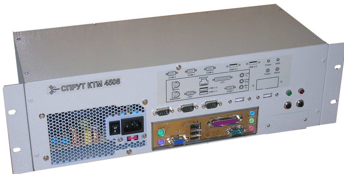
Рисунок 1. Расположение и условные обозначения разъемов наружной панели корпуса контроллера
