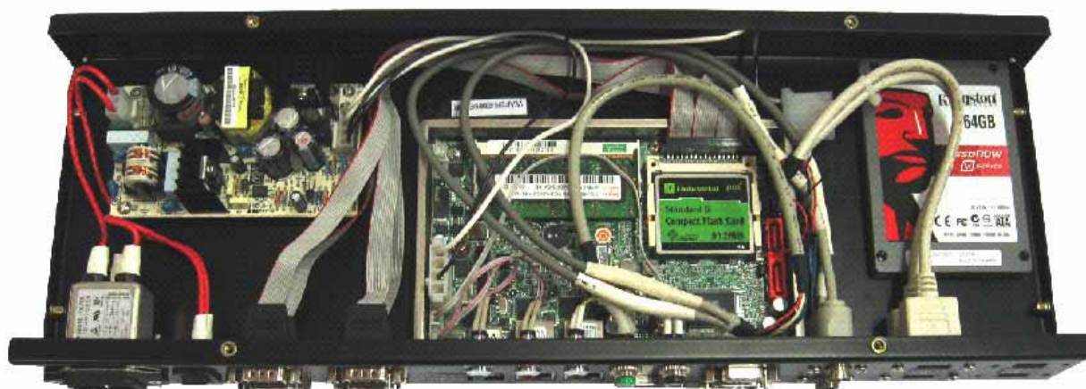
Рисунок 3. Расположение составных частей контроллера со снятой верхней панелью
